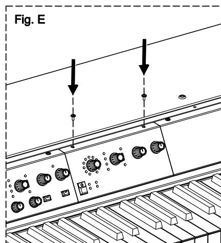
7. Riposizionare la barra di copertura sul top e sul pannello frontale e bloccarla con le viti svitate al punto 2.
