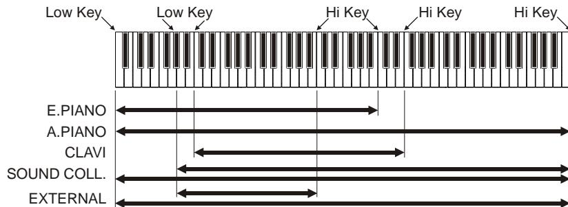
Tenendo premuto il pulsante [<] e premendo un tasto della tastiera è possibile selezionare la nota *Lower Key*. Tenendo premuto [>] e premendo un tasto della tastiera si seleziona la nota *Upper Key*.
