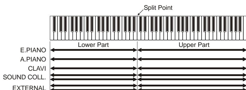
Per assegnare un modulo ad una delle due parti, posizionare tramite il dial data entry od i pulsanti [<] o [>] il cursore sulla linea del modulo interessato e premere il dial. Il parametro *Split Part* indica la parte di tastiera assegnata al modulo selezionato. Per modificare il valore utilizzare il dial data entry. Una volta effettuata la selezione premere [EXIT] per tornare alla videata precedente.
