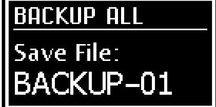
2. Utilizzando il dial data entry selezionare il numero di backup desiderato, che corrisponderà al nome del file .L7B e premere il dial data entry, viene visualizzato il messaggio “Executing Backup...”. Qualora nell'unità flash USB sia già presente un file con il nome scelto, viene visualizzato il messaggio “*BACKUP-XX already exists. Overwrite?*” con il quale il sistema chiede se sovrascrivere il file. Premere il dial data entry per confermare o [EXIT] per annullare.
